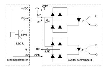
Fig.2-6.3 Drain wiring mode
