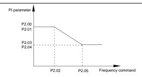
Fig.5-2PI parameter schematic diagram
